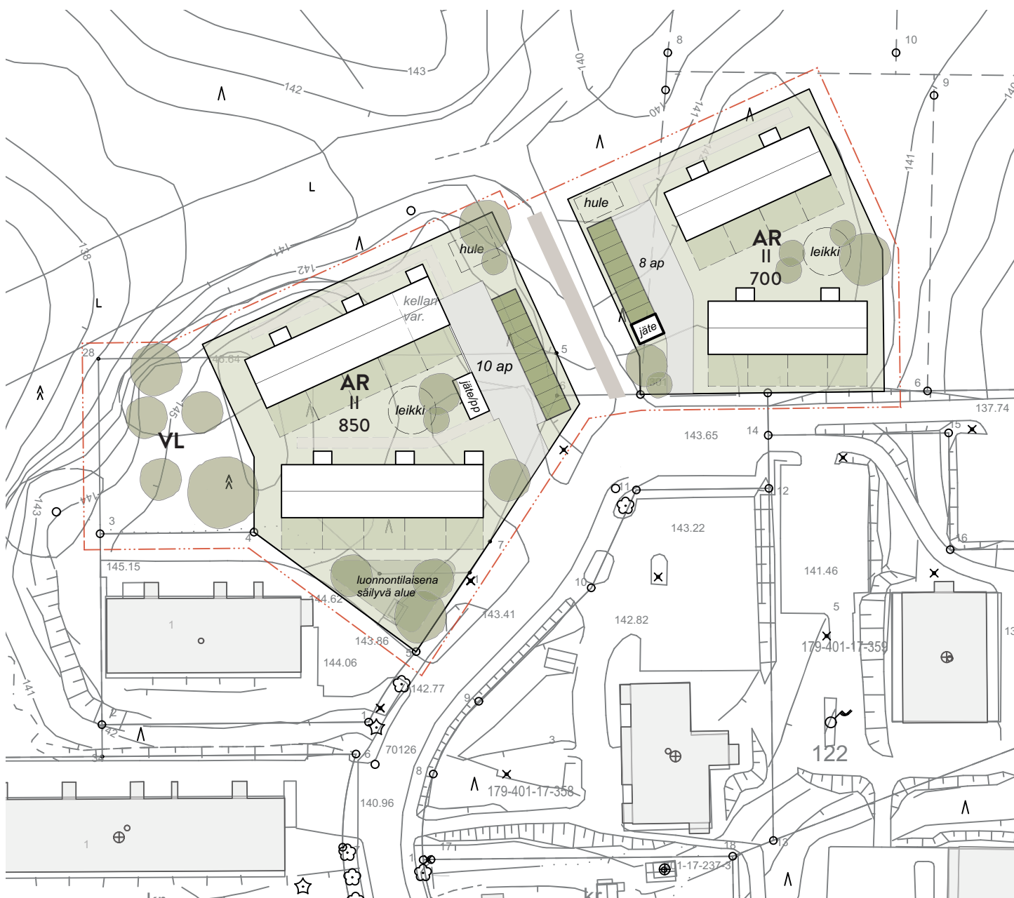
Asemapiirros: Esimerkki asemakaavan mahdollistamasta uudisrakentamisesta (yksikerroksisia rivitaloja)
